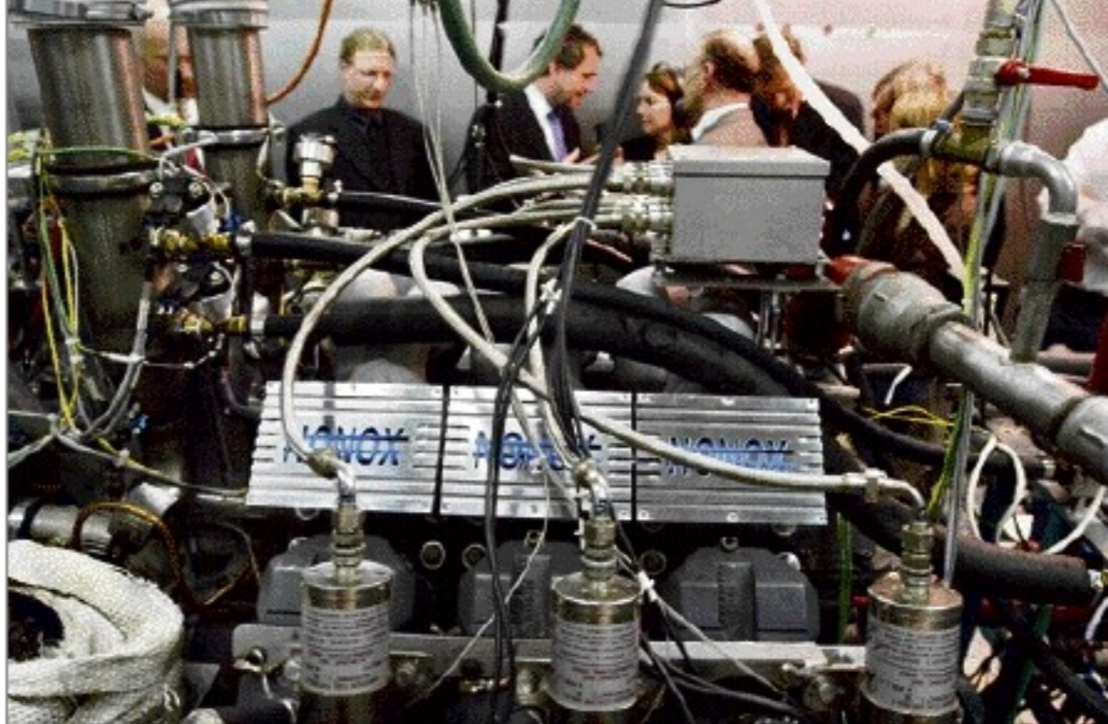
Nonox uit Hoensbroek ontwikkelde een motor die op aardgas loopt. De motor is net zo krachtig als een dieselmotor, maar veel zuiniger in energieverbruik. Foto Chris Keulen
